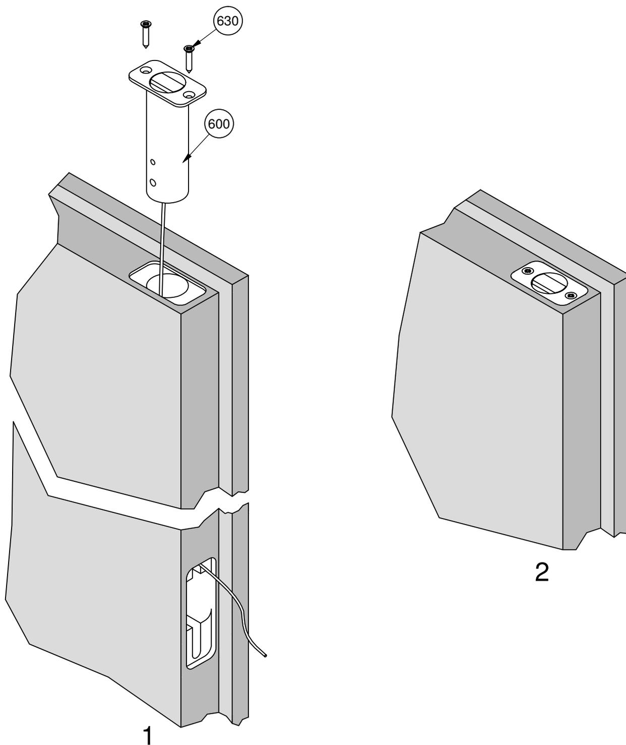
1) Inserire il blocco scrocco (600) sul lato superiore dell' anta
